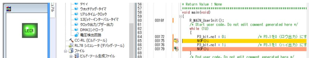
再度、グリーン右向きの三角のボタンをクリックすると、下のように、下側の「NOP();」の行が黄色になり、その上の「P3\_bit.no1 = 1;」が実行された結果 LED が消灯したことになります。
