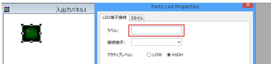
ここでは、「LED1」とでもしておきます。次に、「接続端子」の欄の右側のメニューをクリックしてリストを表示し、接続する端子として「P31/.....」を指定します。
